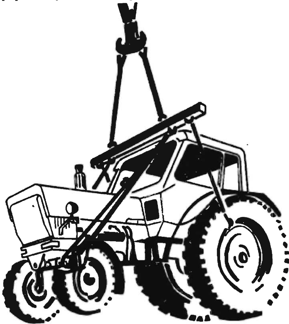
Рис. 112. Схема захвата трактора тросами.
