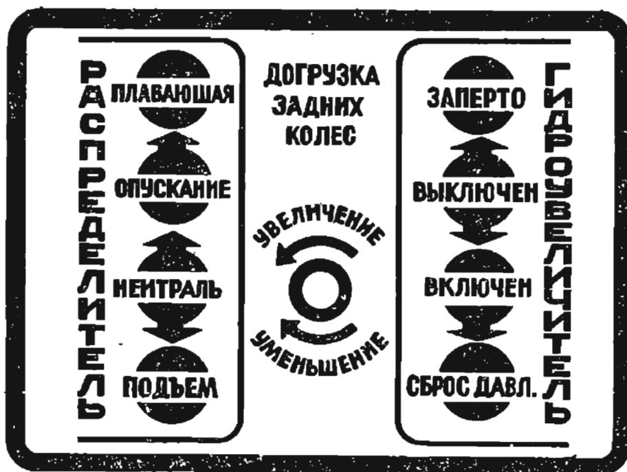
Рис. 7 а. Схема управления гидросистемой трактора.
